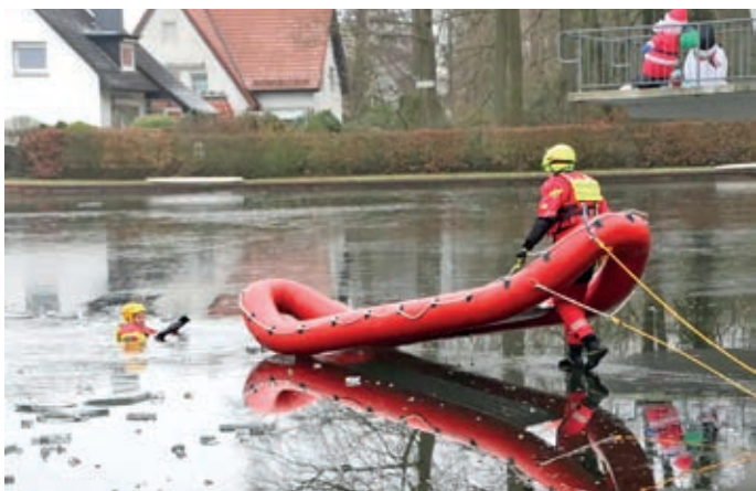
Der „Eisretter“ ist so gebaut, dass er zur der eingebrochenen Person geschoben werden kann.
