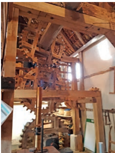
Drei übereinander angeordnete hölzerne Zahnräder treiben die Achse an.
