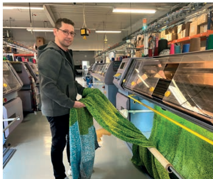
Insgesamt 13 Strickmaschinen hat Waldemar Winter. Diese hier produziert gerade den Stoff für ein Kleid.
