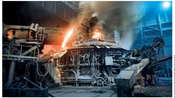
Das Ersetzen des alten Hochofens durch einen Elektrolichtbogenofen spart 80 Prozent der CO 2 -Emissionen.
