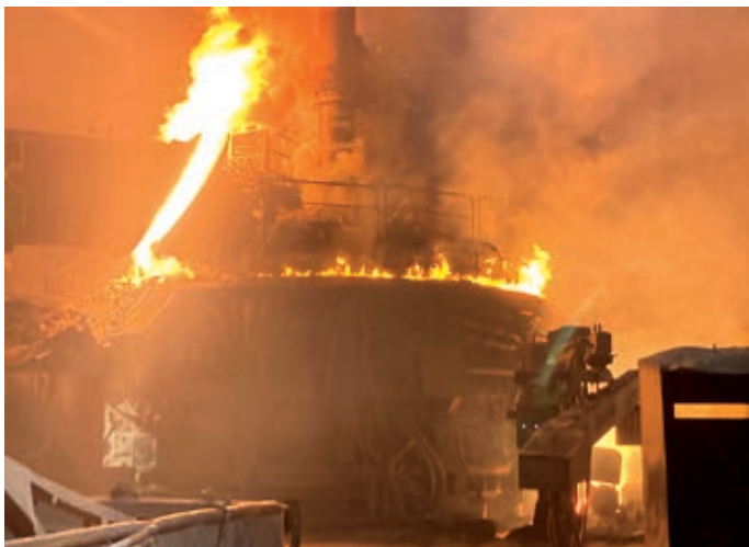
Der Gleichstrom-Elektrolichtbogenofen – auch Höllenofen genannt – ist das Herzstück des Stahlwerks. Er wird weitgehend mit Strom betrieben.
